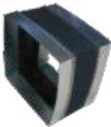
Accesorio recomendado para aislamiento de vibraciones en instalaciones de HVAC. Fabricado con 35 mm de lámina galvanizada calibre 28 en cada extremo y 60 mm de una base poliéster con recubrimiento de PVC por ambos lados.
